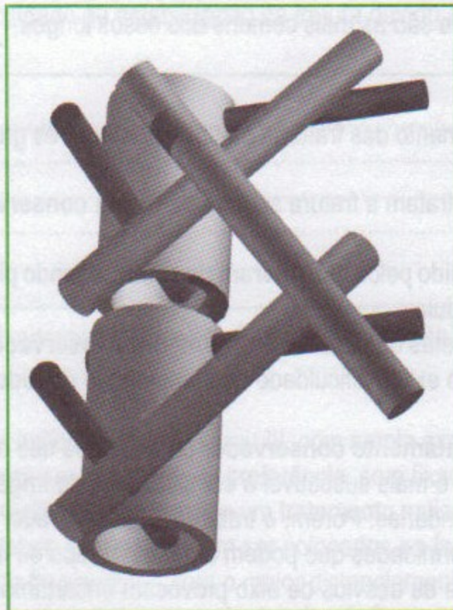
Figura 12 – Esquema da montagem tubo a tubo.
